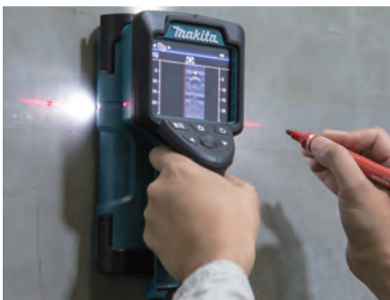
Οδηγός Laser για να υποδείξει το κατακόρυφο κέντρο του αισθητήρα και τον άξονα της κατεύθυνσης σάρωσης. Βοηθά στη σωστή σάρωση κατά μήκος του οριζώντιου άξονα
